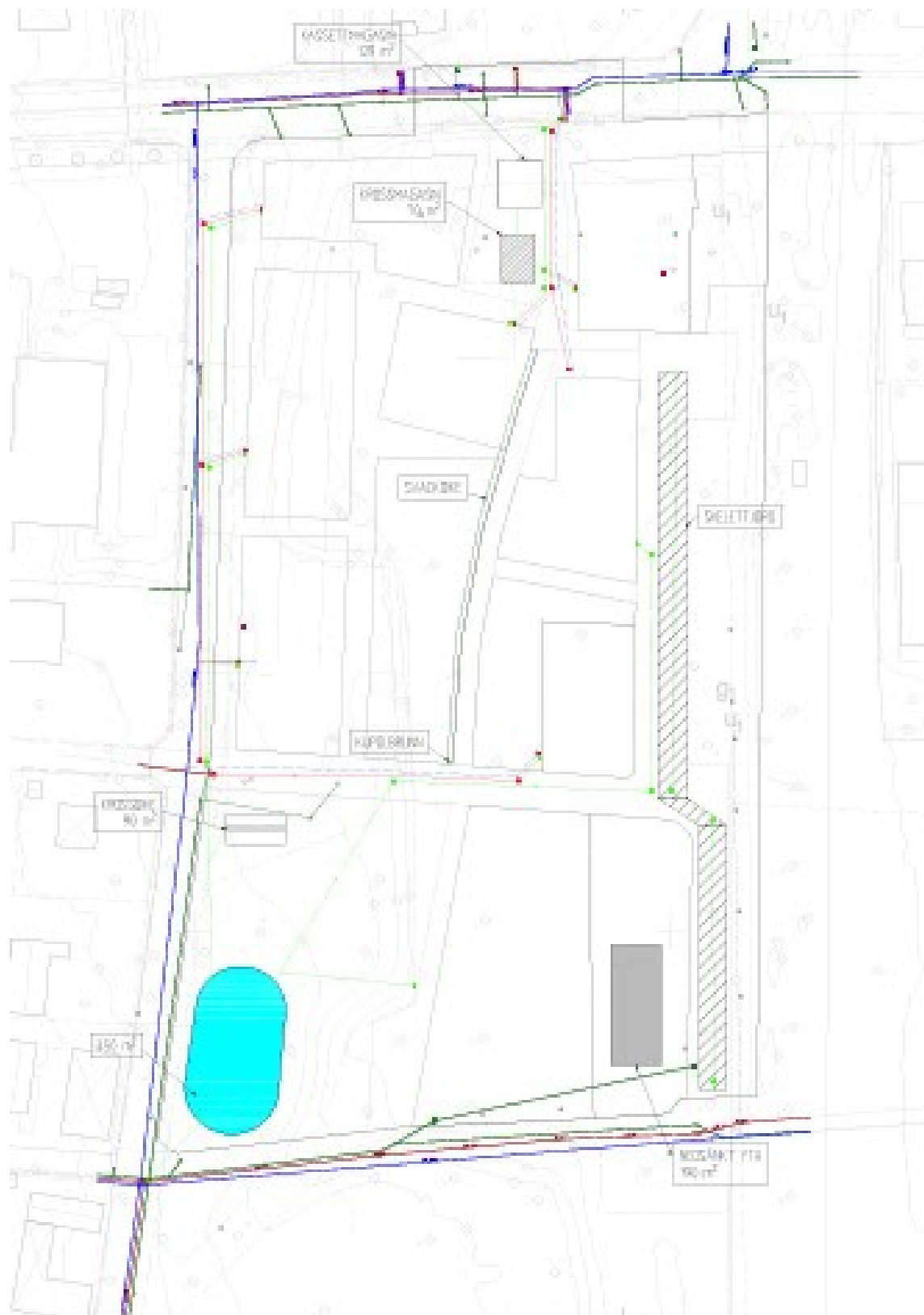
Bild ovan visar ledningsdragning med anslutningspunkter för spill och dricksvatten och för dagvattenhantering inom planområdet. Även fördröjningsytor för dagvatten är redovisade, i enlighet med Dagvattenutredning utförd 2022-04-08 och Spill- och vattenutredning utförd 2022-05-18.
